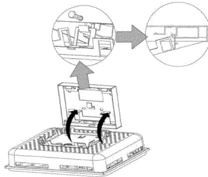
④ ブラケットをダブルナット(M8)にて緩みのないように確実に締め付け、天井に取り付けてください。
