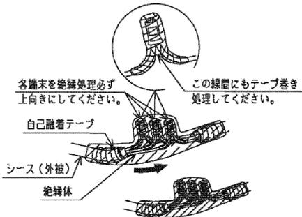
自己融着テープにて各端末を絶縁処理した後、さらにシース(外被)と絶縁体の間に自己融着テープを巻き、確実に防水処理を行い、シース部側から絶縁処理を行ってください。
