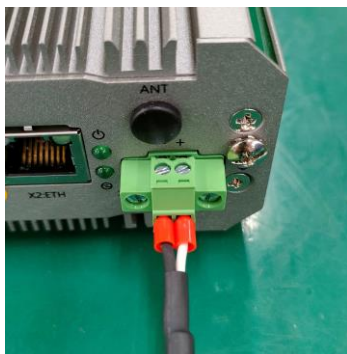
図 12 ゲートウェイ本体への AC アダプタ電源端子の接続
