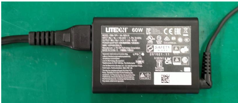
図 14 AC アダプタへの AC アダプタ用ケーブルの接続
