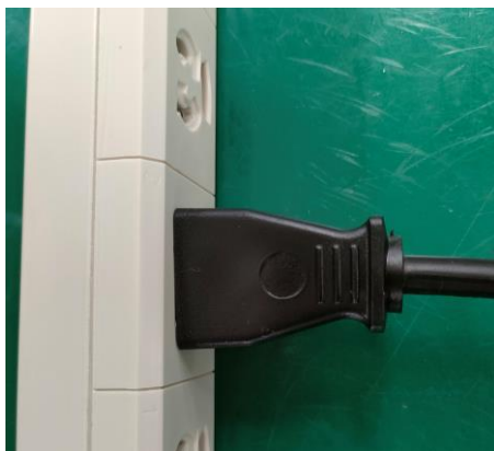
図 15 AC アダプタ用ケーブルの3P プラグの差し込み図
