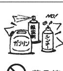
防水ランプソケットの樹脂部には、水・洗剤・薬品などは使用しないでください。部品の劣化や感電・漏電・火災の原因となります。
