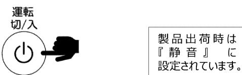
前回動作時の風量の『動作表示LED』が点灯します。
