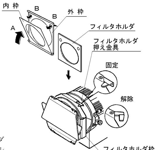
フィルタホルダ取付け後は、必ずフィルタホルダ抑え金具を固定状態にしてください。
