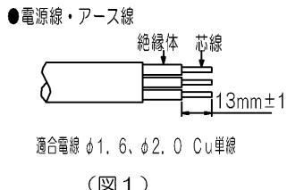
適合電線  $\phi 1.6, \phi 2.0$  Cu単線
