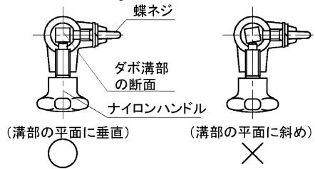
※ ヨークスターはハンガーの回り止めのためにダボの溝部が平面になっています。そのためナイロンハンドルだけを緩めてもハンガーの向きを変えることができません。ハンガーの向きを変えるときは蝶ネジも緩めてください。蝶ネジを緩めると落下防止が解除されてしまうため、ナイロンハンドル、蝶ネジを緩めるときは、必ずヨークスターを一旦下におろし安定した安全な場所で作業を行ってください。
