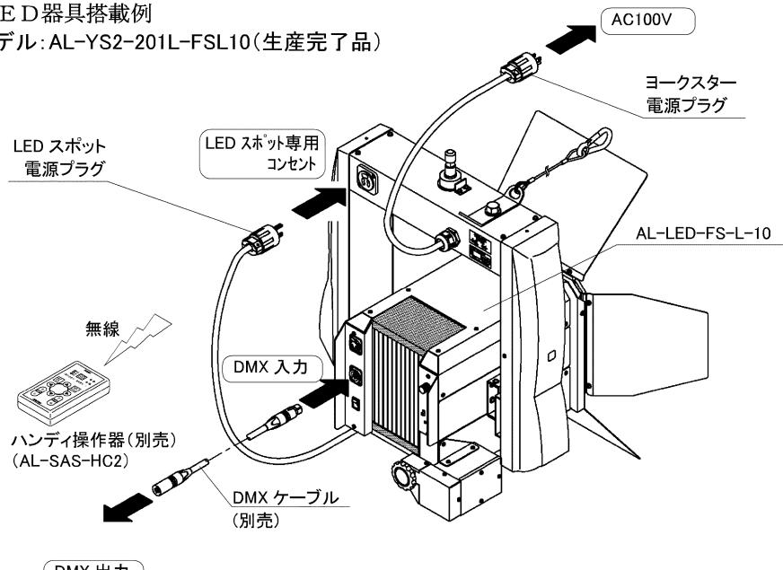
※ LEDスポットの電源コードはヨークスターのLEDスポット専用コンセントに接続してください。ヨークスターの電源プラグから供給される電源と連動します。
