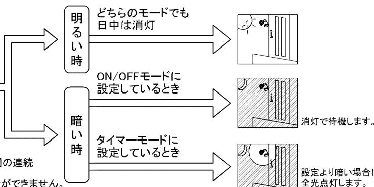
※連続点灯中に壁スイッチ操作(約1秒以内のOFF→ON)を行った場合、タイマーがリセットされ、その時点から約8時間の連続点灯となります。
