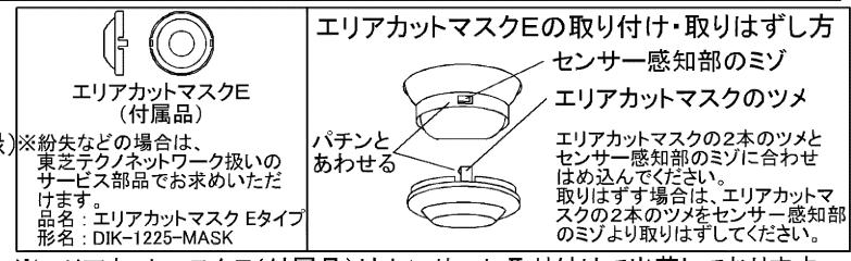
※エリアカットマスクE(付属品)はセンサーに取り付けて出荷しております。
