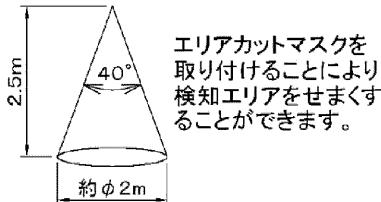
※エリアカットマスクE(付属品)はセンサーに取り付けて出荷しております。
