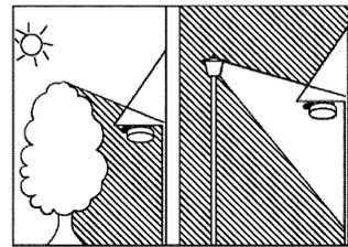
前面に障害物のある場所。(透明なガラスでも遮断されます。)
