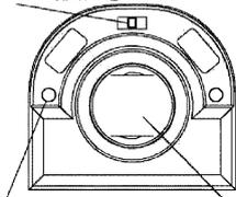
照度センサー 人感センサー検知部(レンズ) ※エアアカットマスクE(付属品)はセンサーに取り付けて出荷しております。
