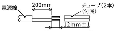
**適合電線 $\phi 1.6$ 、 $\phi 2.0$ 単線**
