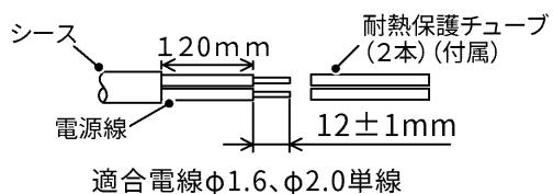
適合電線 $\phi 1.6$ 、 $\phi 2.0$ 単線
