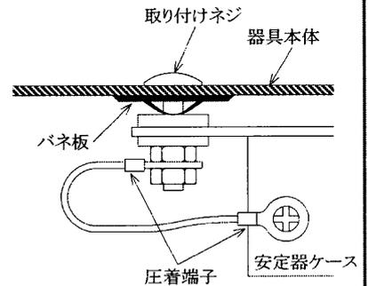
3. 安定器ケースと取り付けネジとの接続にアース座金を用いているものがあります。バネ板などで固定された取り付けネジ側に、アース座金を用いていれば接地はなされます。アース座金については、お問い合わせください。
