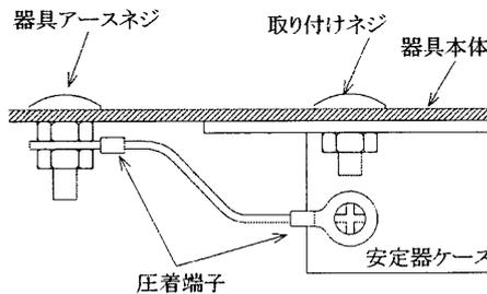
2. バネ板などで固定された取り付けネジは、器具にアースされていますので安定器ケースをその取り付けネジにアースすれば接地はなされます。固定ネジ側でアースを取ってください。
