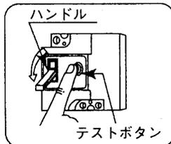
■主幹ブレーカ動作確認手順 主幹ブレーカが動作することを月1回程度確認することをお奨めします。
