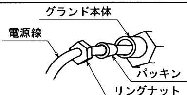
口出線の結線が不完全な場合には、絶縁不良による発熱、火災の原因となります。
