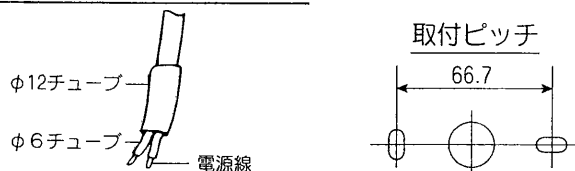
図－２ 保護チューブの取付方
