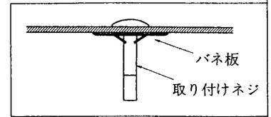
2. パネ板：安定器の取り付けネジがパネ板で器具に固定されているものがある場合、そのネジと穴をそのまま使用してください。
