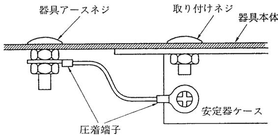
2. パネ板などで固定された取り付けネジは、器具にアースされていますので安定器ケースをその取り付けネジにアースすれば接地がなされます。固定ネジ側でアースを取ってください。
