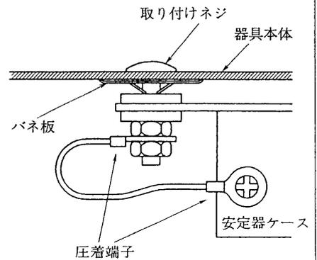
3. 安定器ケースと取り付けネジとの接続にアース座金を用いているものがあります。パネ板などで固定された取り付けネジ側に、アース座金を用いれば接地がなされます。アース座金については、お問い合わせください。
