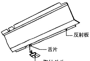
④ 反射板をつまみながら本体の取付ダボに反射板の舌片を差し込んで確実に取り付けてください。
