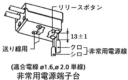
③ 電源線、アース線の挿入部は、反射板との当たりを防ぐため小さく曲げ、端子台に押しつけてください。
