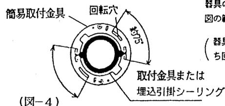
器具の天井取り付けには図の範囲で調整できます。
