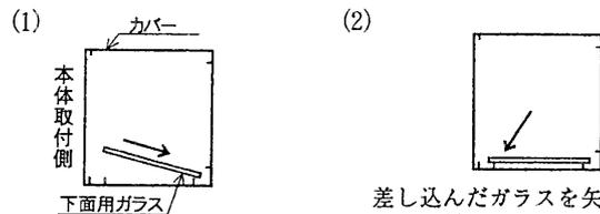
図Aの様に下面用ガラスを矢印方向に差込む
