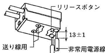
(適合電線  $\phi$ 1.6,  $\phi$ 2.0 単線)
