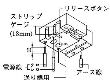
③ 電源線、アース線の挿入部は、反射板との当たりを防ぐため小さく曲げ、端子台に押しつけてください。
