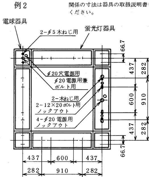
注) 蛍光灯器具のくわしい取付穴、電源穴関係の寸法は器具の取扱説明書をご覧ください。
