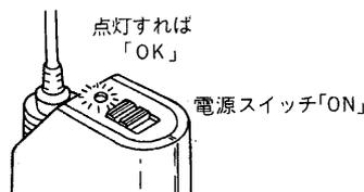
電池収納後、電源スイッチを「ON」にしたとき、電源表示灯が点灯すれば動作OKです。電源表示灯が点滅した場合、電池が消耗していますので早めに新品の電池と交換してください。
