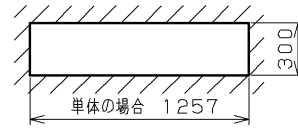
N連結の場合 1275×N-20 埋込み穴寸法
