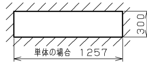
N連結の場合 1275×N-20 埋込み穴寸法
