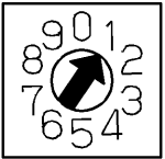
DF-70170-PD コントロールクス設定スイッチ図
