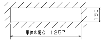
N連結の場合 1275×N-20 埋込み寸法
