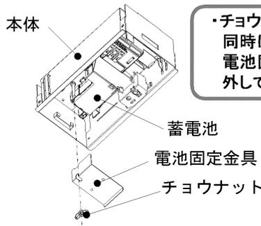
・チョウナットを外すと電池固定金具も同時に外れます。
