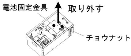
②蓄電池を取り付けて、外した電池固定金具を取り付ける。
