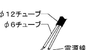
図-5 耐熱保護チューブの取付方
