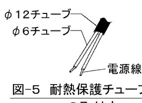
図-5 耐熱保護チューブの取付方
