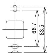
図-3 取り付け寸法図
