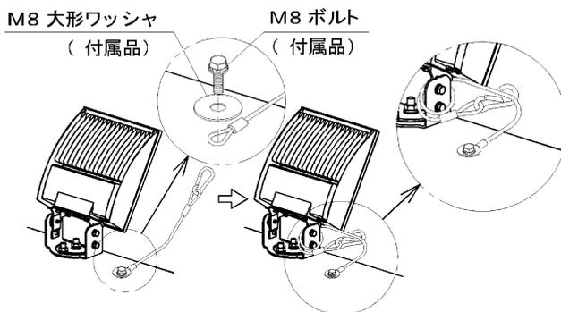
1. ワイヤーのリング部を、建物の堅牢な箇所にもM8ボルト(付属品)とM8大形ワッシャ(付属品)で固定してください。
