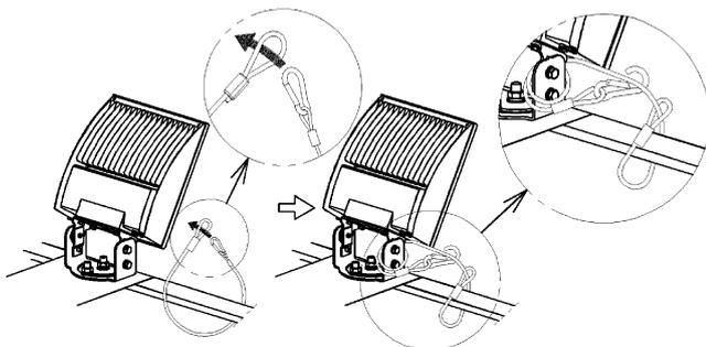
1. 鋼材にワイヤーを1周させ、カラビナ側先端を反対側リング部に通してください。
