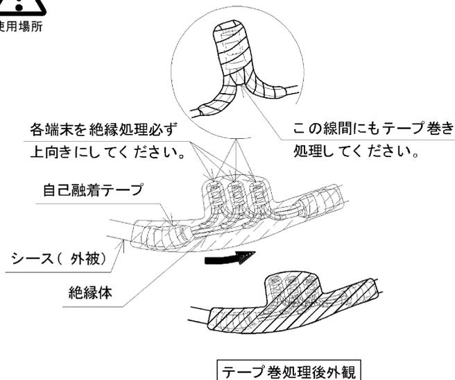
自己融着テープにより各端末を絶縁処理した後に、さらにシース(外被)と絶縁体の間に自己融着テープを巻き、確実に防水処理を行い、シース部側から絶縁処理を行ってください。
