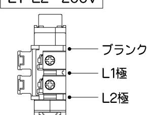
相切替時に付属の□・(L1)、□・・(L2)シールを貼ってください。※1Eタイプは、N極固定です。(100V専用)
