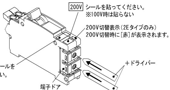
2EタイプはL1極にプラグイン選択端子が無いことを確認して他極のプラグイン選択端子の位置を切替えてください。
