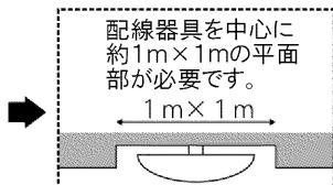
配線器具は必ず丈夫な天井面に確実に取り付けてください。
