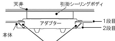
•1回押し上げて、アダプターのツメを金属の段に取り付けてください。アダプターのツメは見えなくなります。
