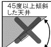
45度以下の傾斜天井に取り付ける場合
