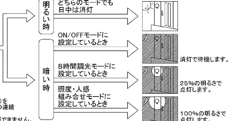
※連続点灯モード中に壁スイッチ操作(約1秒以内のOFF→ON)を行った場合、タイマーがリセットされ、その時点から約8時間の連続点灯となります。
