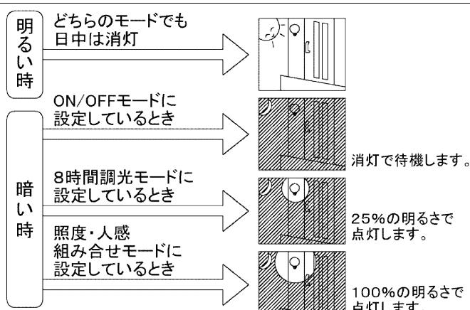
※連続点灯モード中に壁スイッチ操作(約1秒以内のOFF→ON)を行った場合、タイマーがリセットされ、その時点から約8時間の連続点灯となります。
