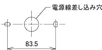
図-2 取り付け寸法図
