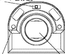
照度センサー 人感センサー検知部(レンズ) ※エリアカットマスクE(付属品)はセンサーに取り付けて出荷しております。
