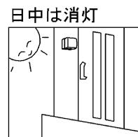
※電源投入直後は約5秒間点灯状態となり、その後、約5秒後に消灯し、センサー待機状態となります。
