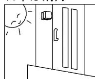
※電源投入直後は約5秒間点灯状態となり、その後、約5秒後に消灯し、センサー待機状態となります。
