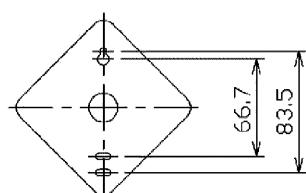
図-2 取り付け寸法図
