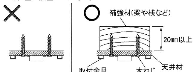
● 埋込引掛けシーリングもしくは取付金具が確実に取り付いていることを確認してください。
