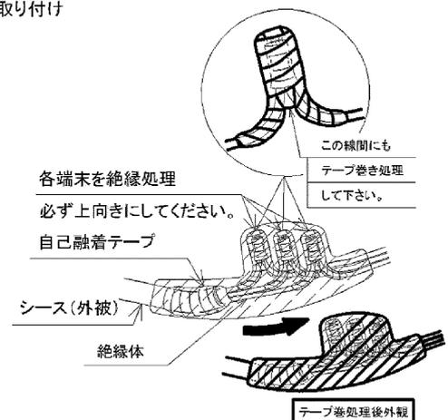
プールの水、湿気の侵入を防ぐため、自己融着テープにより各端末を絶縁処理した後、さらにシース(外被)と絶縁体の間に自己融着テープを巻き、確実に防水処理を行い、シース部側から絶縁処理を行ってください。
