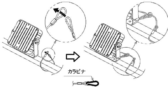
1. 鋼材にワイヤを1周させ、カラビナ側先端を反対側リング部に通してください。
