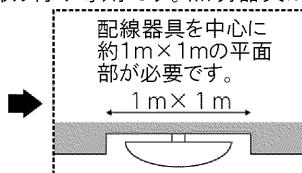
配線器具は必ず丈夫な天井面に確実に取り付けてください。
