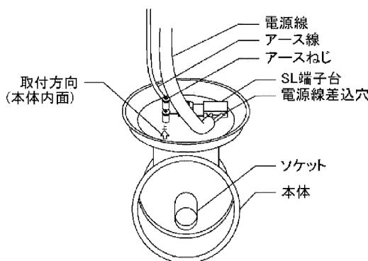
図-3 電源線、アース線接続方法
