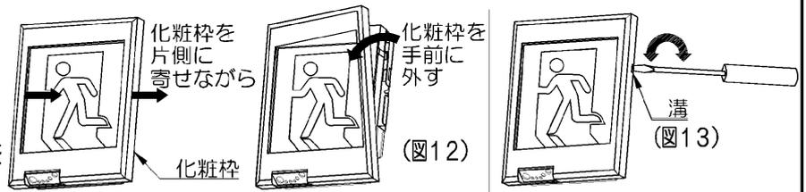
枠が固くてはずしにくい場合は、枠の側面にある溝を利用してドライバー等で引っ掛けはずしてください。(図13)
