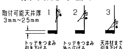
取付金具による固定
