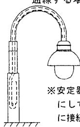
※安定器の出口線までの長さにして器具のソケット端子に接続してください。
