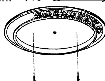
■飾り枠の木ねじ用穴を利用して、付属の4本の木ねじで天井に取付けてください。
